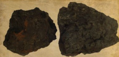
Zależ z wielkiego pieca w Machorach z drobinami limonitu i węgla drewnego. (Z: zbiorów Zabytkowego Zakładu Hutniczego w Maleńcu).
