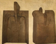
Model drewniany łyski sztyli do węgla, II połowa XX w. (Ze zbiorów Zabłykowego Zakładu Hutniczego w Malenicy)
