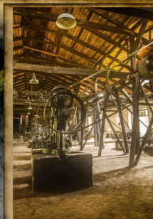
Najwyższy w Polsce wał napędowy 38 m z kołami pasowymi w halę produkcyjną, I połowa XIX w. (Fot. Katarzyna Grizmann)
