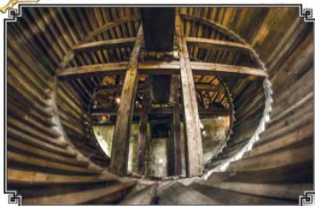
Wnętrze dużego koła wodnego w malenieckiej fabryce żelaza (fot. K. Gritzmann)
